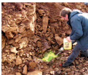
Injections de traceurs dans une perte et un captage.
