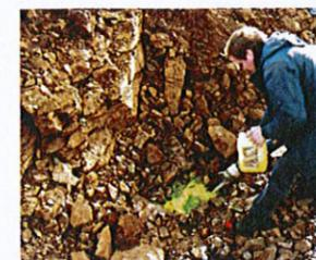
Injections de traceurs dans une perte et un captage.
