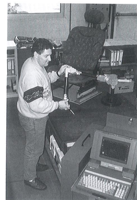
Un technicien travaille sur l'étude d'un siège complet de Twingo à l'aide d'un système de mesure tridimensionnelle portable.
